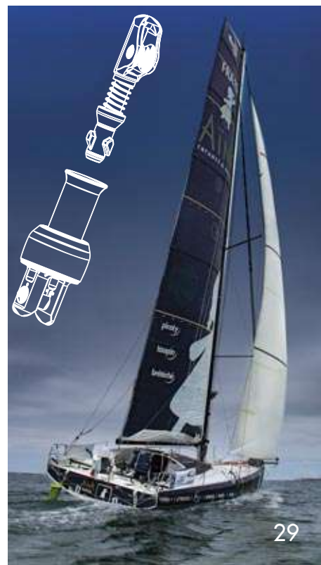
Dogbone serti dans l'alésage à l'intérieur de l'émerillon : fixe la drisse
